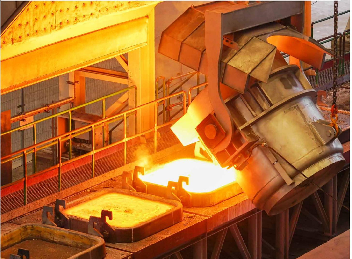
Unsere neue Siliziummetall-Anlage in Island hat am 30. Oktober 2019 den Regelbetrieb aufgenommen. Hier im Bild ist das Abgießen des etwa 1.500 Grad Celsius heißen, flüssigen Siliziummetalls in die Gießrahmen zu sehen, aus denen das Metall nach dem Abkühlen und damit Aushärten herausgebrochen wird. Anschließend wird das Metall entsprechend dem Kundenwunsch konfektioniert.
