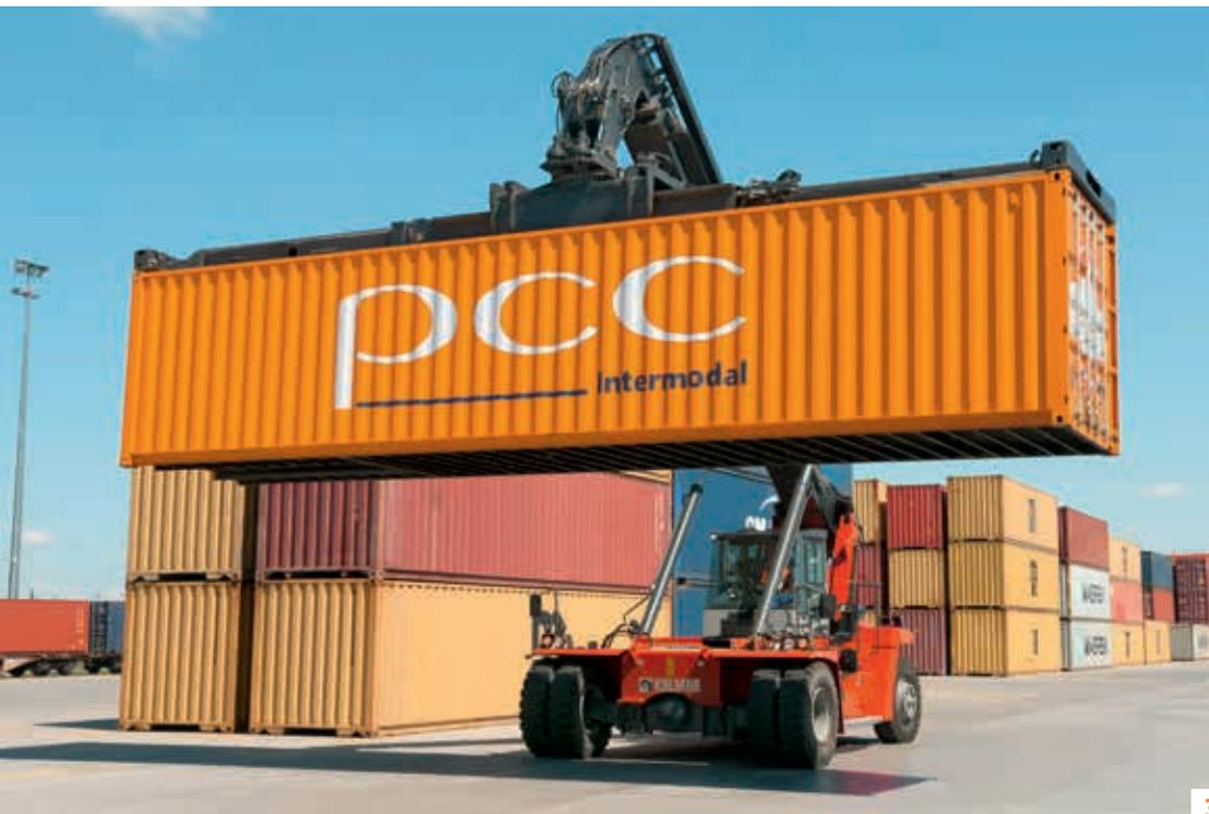
**3** Reachstacker, die wir neben Portalkränen an unseren Terminals einsetzen, ermöglichen ein flexibles Container-Handling.
