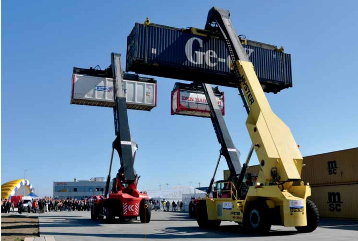
Mit Hilfe von Reachstackern lassen sich Container mit einem Gewicht von bis zu 41 Tonnen aus der zweiten Reihe über die erste Containerreihe heben. Am PCC-Terminal in Kutno sind insgesamt vier Hebezeuge im Einsatz.
